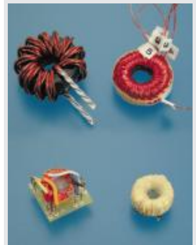
Ringkern-Wickelgüter sind praktisch streufeldlose Spulen mit hoher Induktivität auf kleinstem Raum. Wegen ihrer hohen Aussteuerbarkeit finden sie Anwendung bei Breitbandübertragern, Drosseln und Impulsübertragern.
