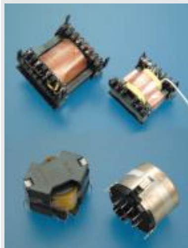
Wickel mit Ferritkernen finden Anwendung bei hohen Frequenzen (5–500 kHz) und wo geringe Kernverluste gefordert sind. Wir fertigen die Typen RM, E, EC, ETD, EP, PQ.
