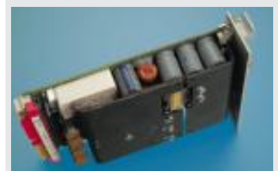
Kundenspezifische Sonderausführungen Impulstrafo im Öl für die Halbleiterzündung, Isolationsfestigkeit von 25 kV und T_e < 5 \text{ pC} bei 13 kV. Trafo mit Wanne, Teilentladungsfestigkeit < 10 \text{ pC} bei 8 kV.
